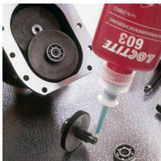
Para retener piezas cilíndricas bien ajustadas (hasta 0,1 mm de holgura), y para aplicar a conexiones cilíndricas que no permiten un desengrase minucioso / Ensayados y aprobados para utilizar en rodamientos.
